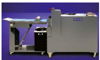
DI-CUT 310 Presse rotative de découpe
