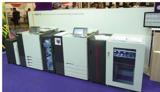
Lancées sur le marché français en mars 2017, les imprimantes ComColor GD ont été spécialement conçues pour l'impression de production. Composé de deux unités d'impression ComColor GD, le RISO T2 est un matériel de production permettant d'imprimer jusqu'à 320 pages par minute en recto-verso. Présenté pour la première fois en France lors du salon Graphitec 2017, le T2 répond à un large éventail de besoins et rend
