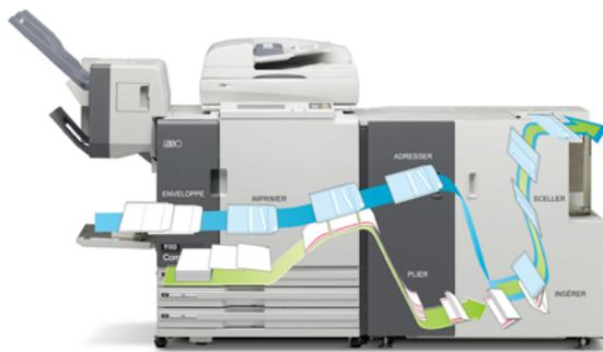
Schéma de fonctionnement de l'impression jet d'encre à froid page / page FORCEJET™ et du système de mise sous pli RISO.
